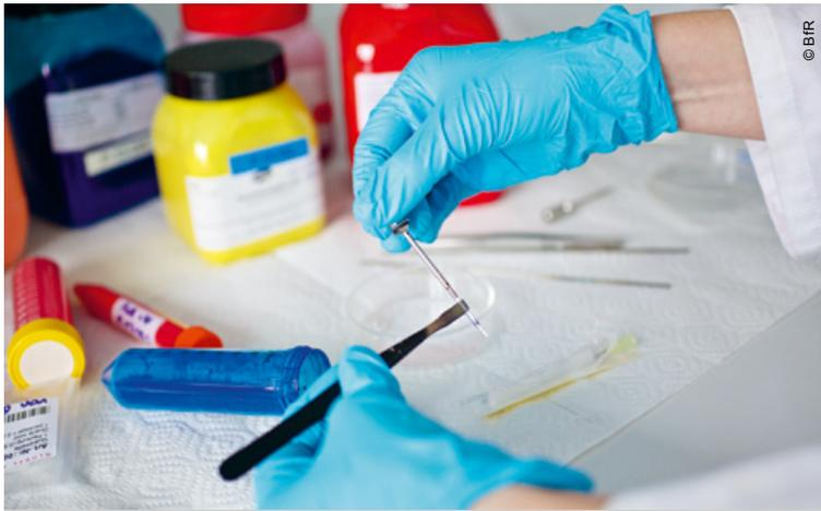
Zur thermischen Behandlung mittels Pyrolyse werden Farbpigmente in Untersuchungsröhrchen gefüllt.
