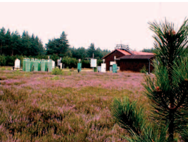
Messstation Waldhof in der Lüneburger Heide mit Niederschlag- und Staubsammlern im Vordergrund
