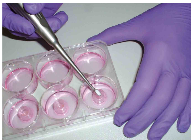
RhE Hautreiztest: Dosierung eines menschlichen Hautmodells mit einer Festsubstanz
