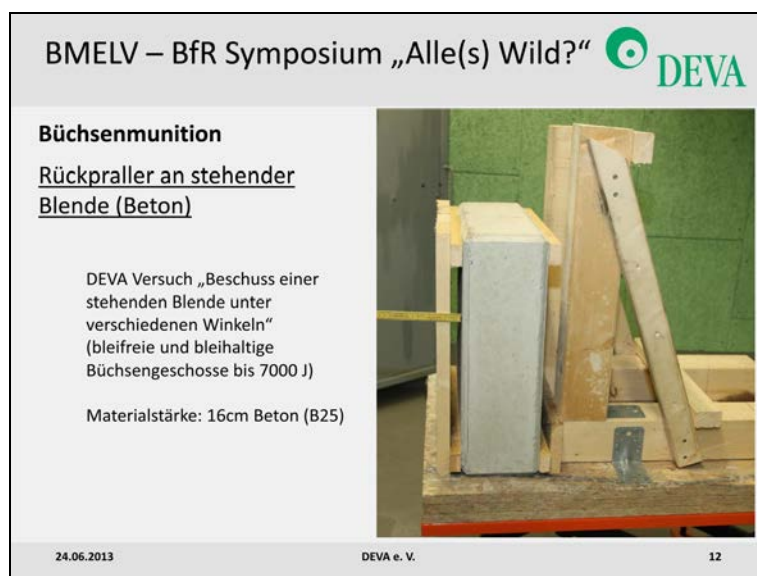
Abb.1: Rückpraller an stehender Blende (Beton)
