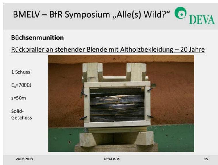
Abb.2: Rückpraller an stehender Blende mit Altholzbekleidung – 20 Jahre
