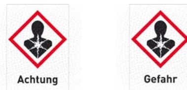
Abbildung 4: Signalworte unterscheiden zwischen der Stärke der Gefahr.
