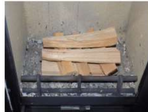
Auswahl an Brennstoffauflagen beim Zünden & Nachlegen - Kaminofen A
