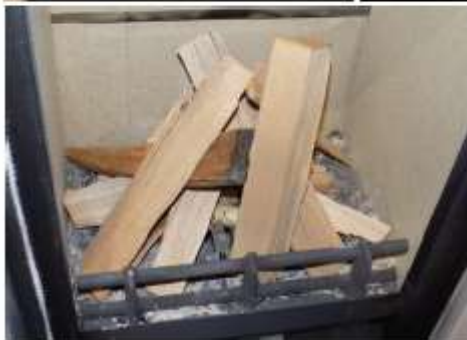
Auswahl an Brennstoffauflagen beim Zünden & Nachlegen - Kaminofen A
