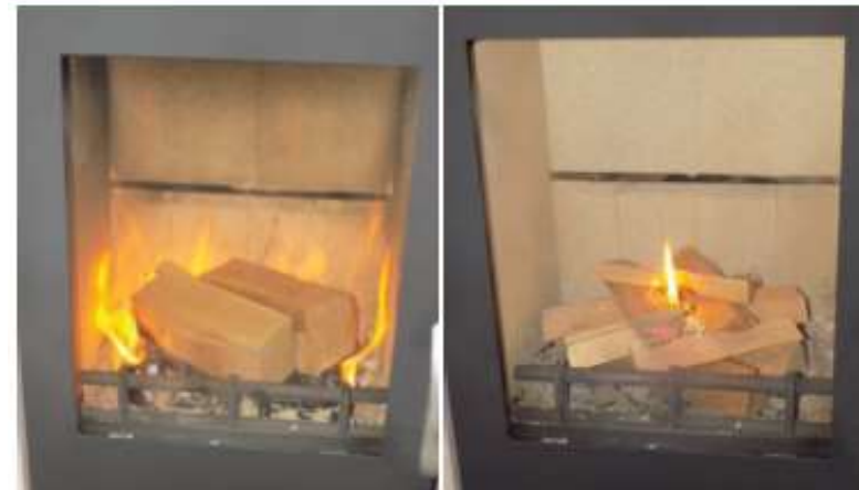
Auswahl an Brennstoffauflagen beim Zünden & Nachlegen - Kaminofen A
